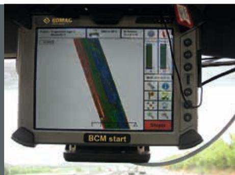
Con il BCM net i vostri operatori hanno sotto controllo tutti i rulli collegati in rete. Ognuno riconosce dove sono necessarie ulteriori passate.
