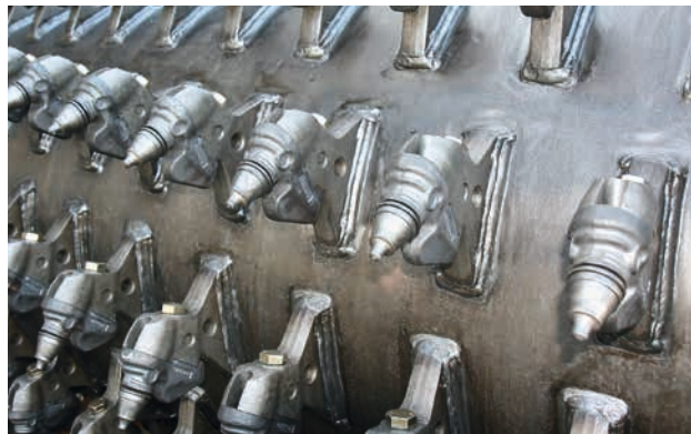
Sistema di portadenti a cambio rapido BOMAG BRS 05.
