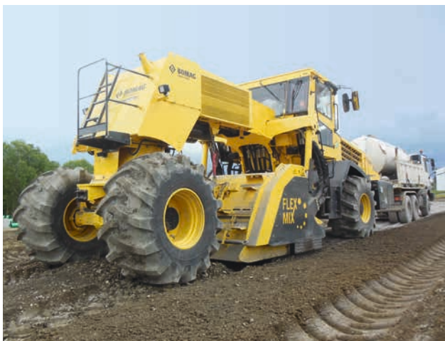
Con lo snodo articolato e l'asse posteriore sterzante, la MPH 600 affronta i terreni difficili senza problemi.
