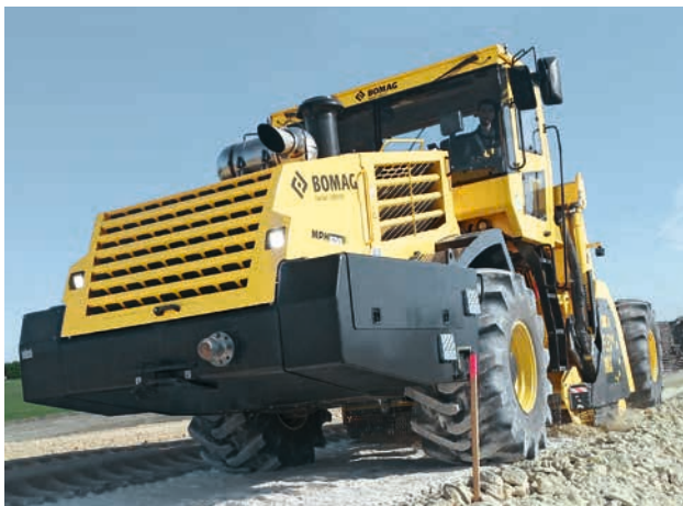
La MPH 600 durante la stabilizzazione del terreno ...
