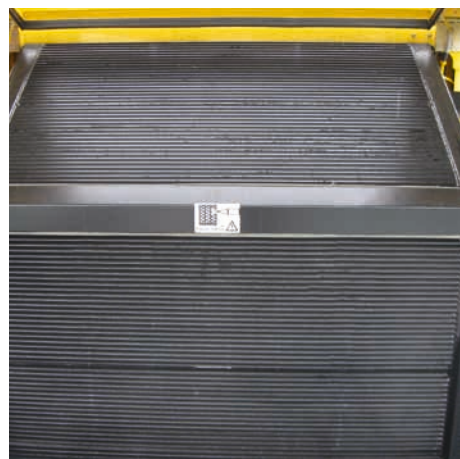
Grandi radiatori con sufficiente riserva di raffreddamento.
