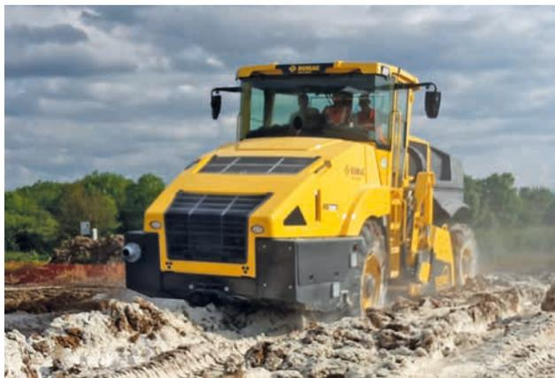
Vantaggio particolare: dispositivo idrostatico di protezione contro sovraccarichi. Si blocca automaticamente in caso di ostacoli inaspettati, che provocherebbero un sovraccarico della trasmissione – ad esempio oggetti medio-grandi, vecchie rotaie o tombini. In questo caso le valvole limitatrici di pressione aprono, per evitare danni al riduttore meccanico.
