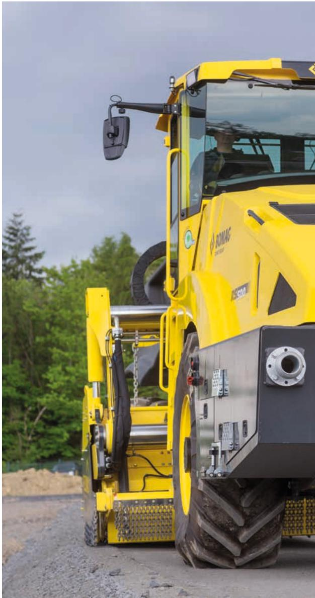
to stradale. Un altro vantaggio del rotore traslabile a sinistra e a destra: nei cantieri stretti delimitati su entrambi i lati, la macchina deve solo indietreggiare, spostando il rotore sull'altro lato – e il lavoro può continuare. Non è necessario effettuare un'inversione di marcia, operazione lunga e costosa.
