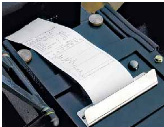
Stampa direttamente in cantiere: valutazione della compattazione.
