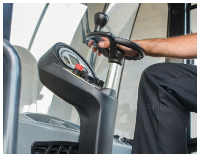
Il piantone dello sterzo: ogni operatore può regolarlo in base alle proprie esigenze.
