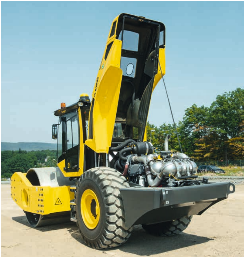
Grande apertura del cofano: tutti i punti di manutenzione facilmente accessibili.
