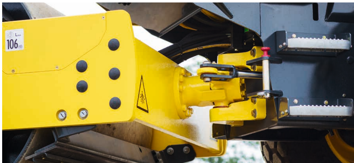
Ben fatto: lo snodo articolato è esente da manutenzione, la macchina non richiede nessuna lubrificazione.
