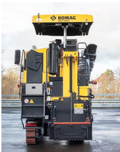
Tettuccio in posizione standard, sedile ruotato.
