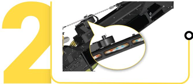
Prima di passare per la soffiatura sul nastro trasportatore, le polveri attraversano il box dell'ION DUST SHIELD.
