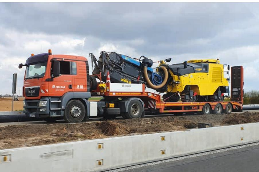
Anche i chili non deludono: il peso base della nuova BM 1000/35-2 è inferiore di 1,5 t rispetto al modello precedente, caratteristica che rende la fresa cingolata da 350 CV più leggera nella rispettiva classe. Con un peso di trasporto inferiore alle 20 t, da questo punto di vista soddisfa le normative più rigorose.
