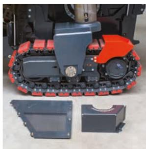
La copertura del nastro è divisa in due, permettendo l'accesso per la manutenzione a una persona.
