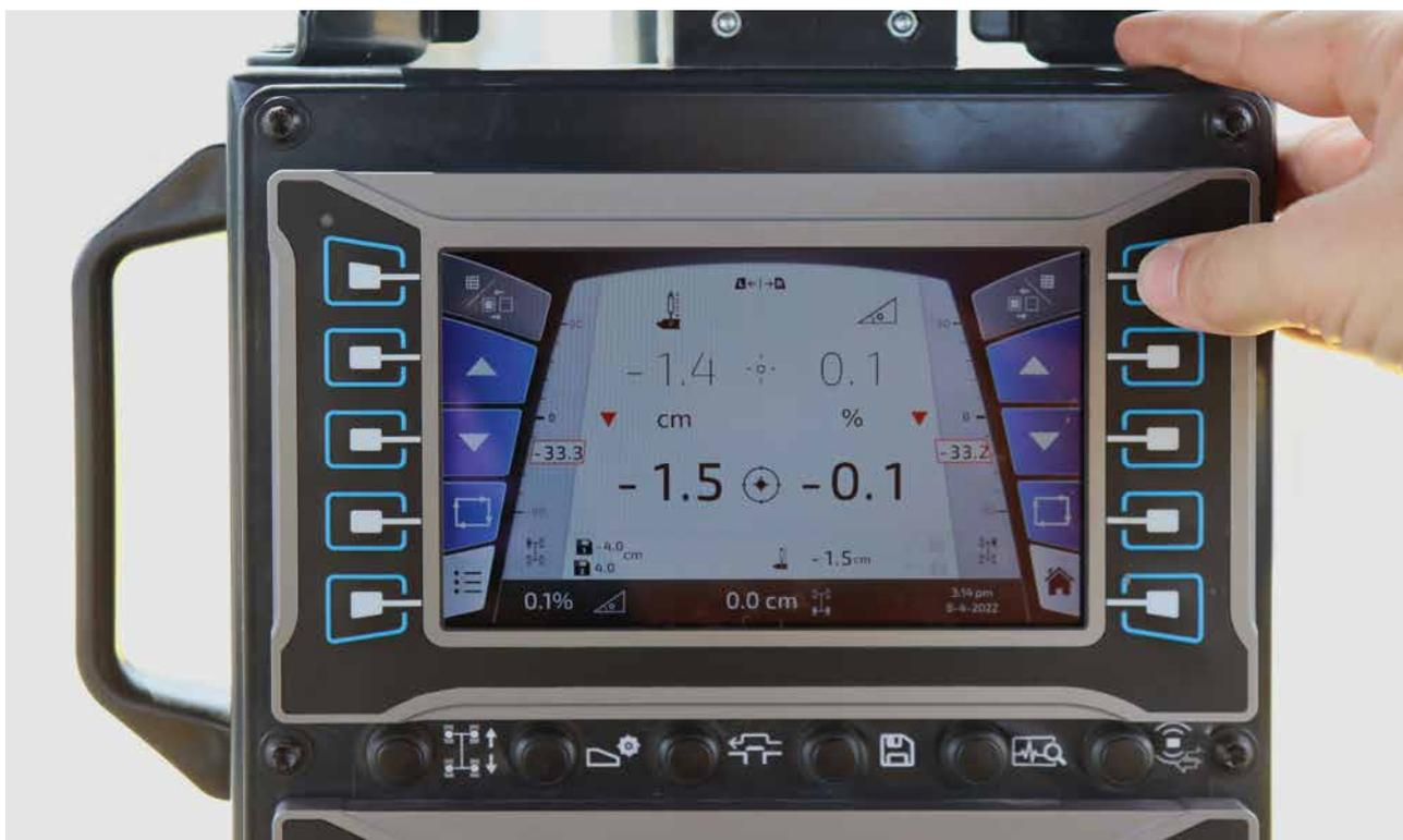
BOMAG Easy Level: i sensori integrati per le paratie laterali, l'inclinazione trasversale, lo scansore anteriore o il sistema Multiplex sono facili da selezionare. Il risultato è una giornata di lavoro facile e senza stress.
