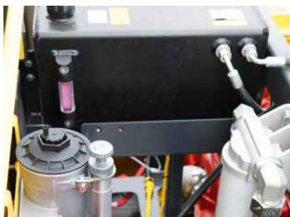
Tutti i serbatoi dei liquidi sono dotati di un indicatore di livello immediatamente visibile.
