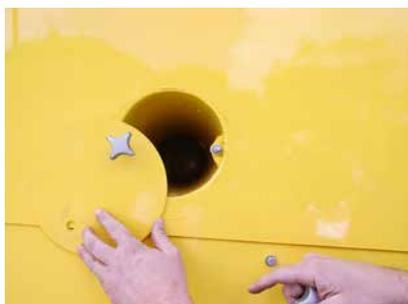
La pulizia del sistema di aspirazione della polvere all'interno della macchina è facile da raggiungere e garantisce il perfetto funzionamento.
