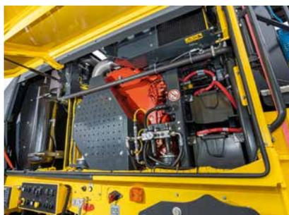
Anche le batterie e l'impianto ad aria compressa sono facilmente accessibili lateralmente.
