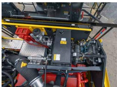
Tutti i filtri pertinenti sono facilmente accessibili dal vano motore.
