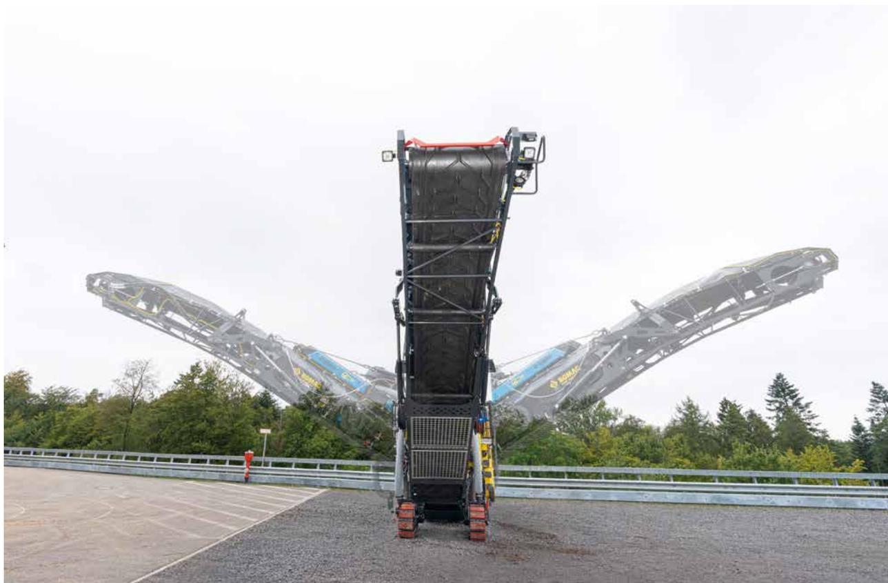
L'angolo di brandeggio di 130° del nastro trasportatore assicura la massima maneggevolezza e flessibilità durante il caricamento dell'autocarro.
