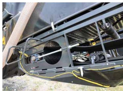
Facile manutenzione del nastro trasportatore: la trasmissione può essere rimossa per la manutenzione senza complicate operazioni di smontaggio.
