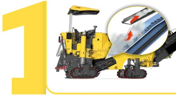
Innanzitutto le polveri vengono aspirate nel punto in cui si formano (nel passaggio tra il vano di fresatura e il nastro trasportatore).
