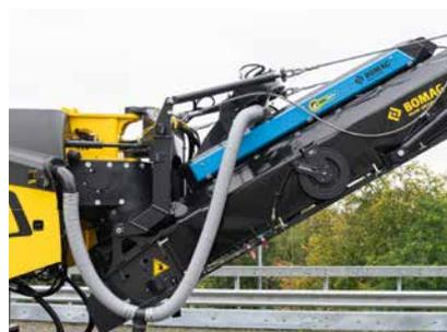
Semplicità geniale: l'ION DUST SHIELD BOMAG per un'efficace riduzione delle polveri sottili senza impiegare filtri.
