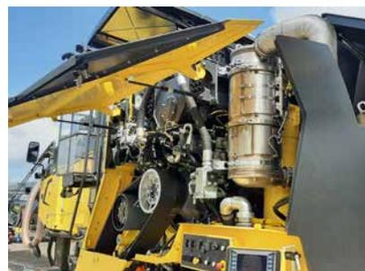
Quattro vani di manutenzione di facile accesso consentono di raggiungere perfettamente l'idropultrice, l'impianto idraulico del nastro trasportatore, la trasmissione della fresa e il motore.
