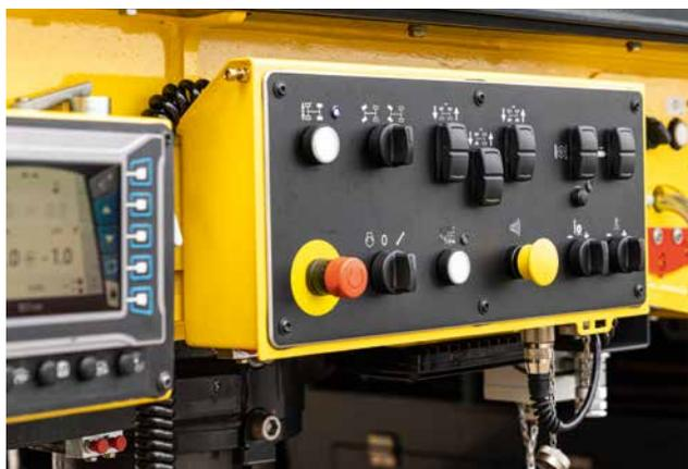
Dotazione di prima qualità per il secondo operatore: pulsantiera e display aggiuntivo sulla cabina di comando a terra.
