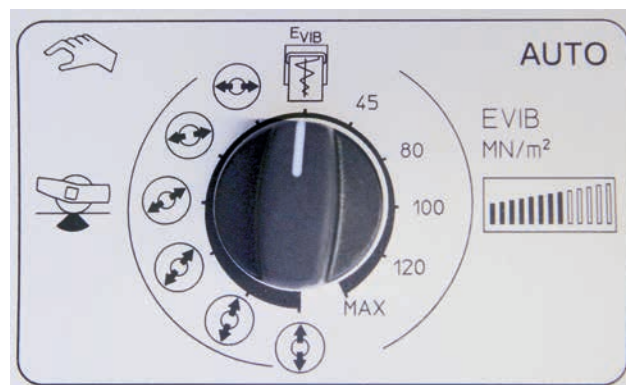
In manuale o in automatico – un unico interruttore per tutte le funzioni.
