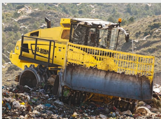
Compattazione ottimale con il giunto oscillante, grazie al quale si ottiene una buona distribuzione del peso sulle ruote di compattazione.
