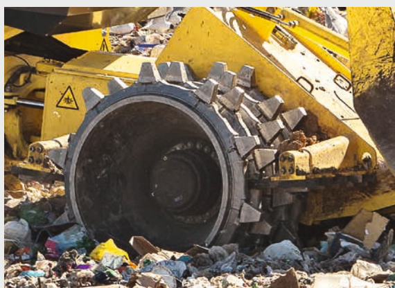
I raschiatori garantiscono ruote pulite e una compattazione perfetta.
