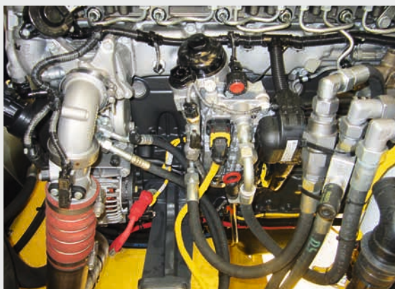
Filtraggio del carburante multi stadio.
