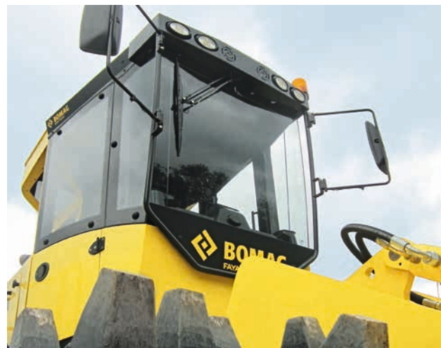
Cabina confortevole a norma ROPS e FOPS.
