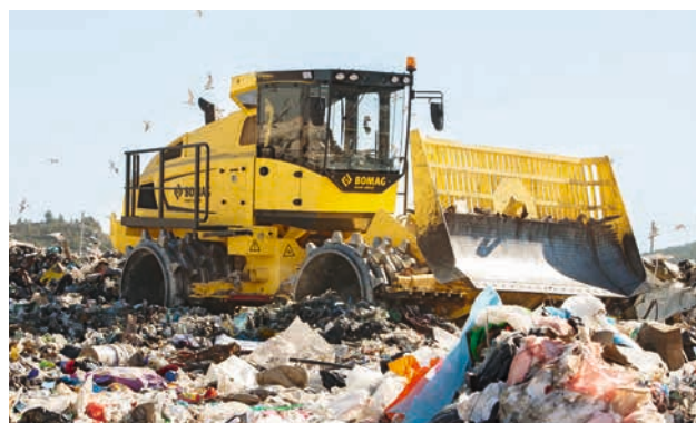
Versione RB con lama a semi-U.
