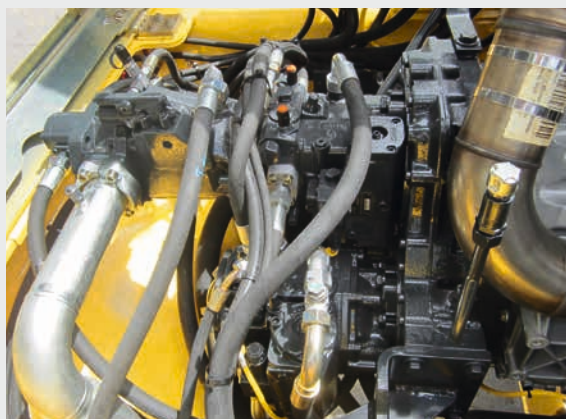
Trazione idraulica delle ruote con "controllo del carico limite" (regolazione della velocità in funzione del carico) (BC 473).
