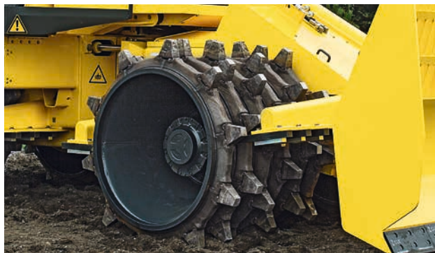
Ruote saldate con conicità interna su entrambi i lati per la massima stabilità (Premium).
