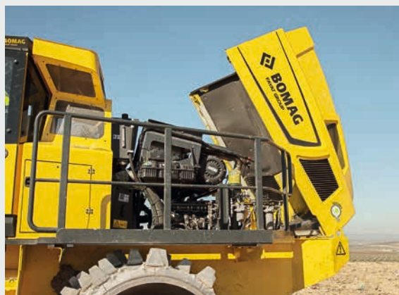
Facilità di accesso a tutti i punti di manutenzione.
