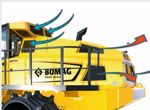
Aspirazione dell'aria di raffreddamento e di combustione in alto, in modo da ridurre al minimo l'incidenza della polvere.
