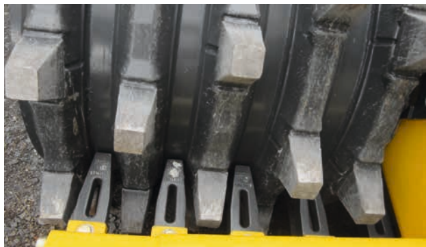
Raschiatore regolabile per lavorare senza interruzioni.
