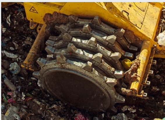
Ruote sempre pulite con i raschiatori (compattazione ottimale).
