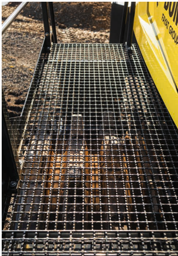
Le scale e la struttura della piattaforma garantiscono una pulizia costante.
