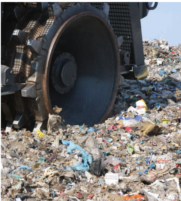
I raschiatori garantiscono ruote pulite e una compattazione perfetta.
