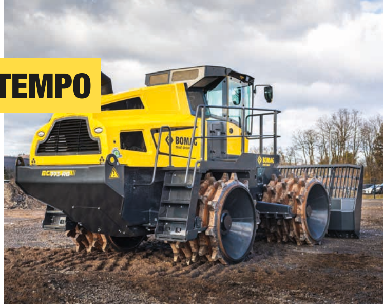
La piattaforma di servizio consente l'accesso alla zona di manutenzione.
