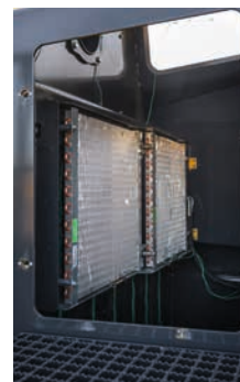
Accesso al radiatore e al vano di manutenzione per il climatizzatore.
