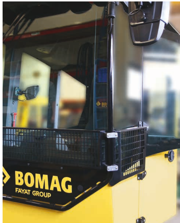
La griglia di protezione cabina previene i danni ai cristalli della cabina.
