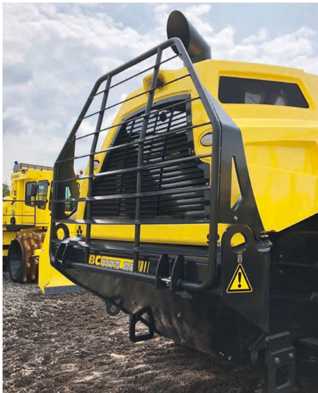
Il paraurti posteriore protegge la parte posteriore del cofano dai danni.
