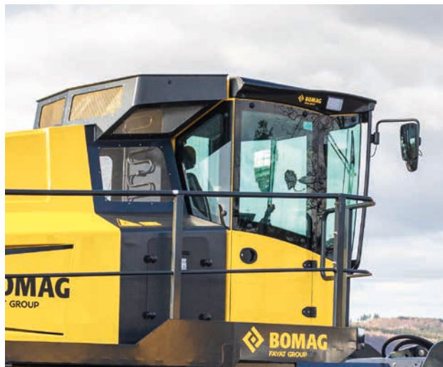
Cabina ROPS/FOPS con vetri di sicurezza a 360°.
