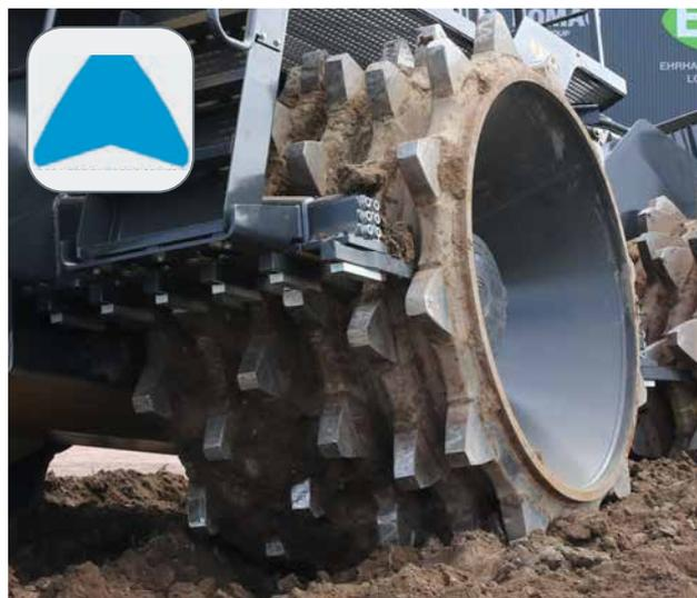
Ruote BOMAG con denti saldati.
