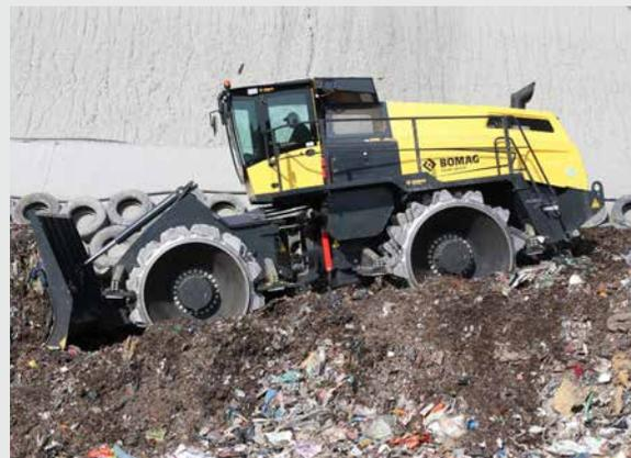
Compattazione ottimale con il giunto oscillante, per un'eccellente distribuzione dei carichi sulle ruote di compattazione.
