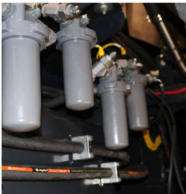
Sistema di filtraggio idraulico.
