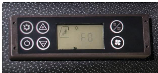
Pannello di controllo dell'impianto di riscaldamento automatico e del climatizzatore.
