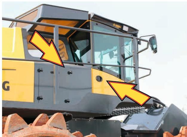
Accesso al radiatore e all'apertura di manutenzione per il climatizzatore.
