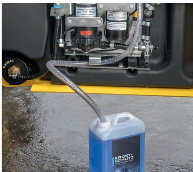
Antigelo per tubi e ugelli di irrigazione: basta aprire la chiusura a vite per far fuoriuscire l'acqua in eccesso, quindi effettuare il risciacquo automatico dei tubi e degli ugelli di irrigazione con l'antigelo.
