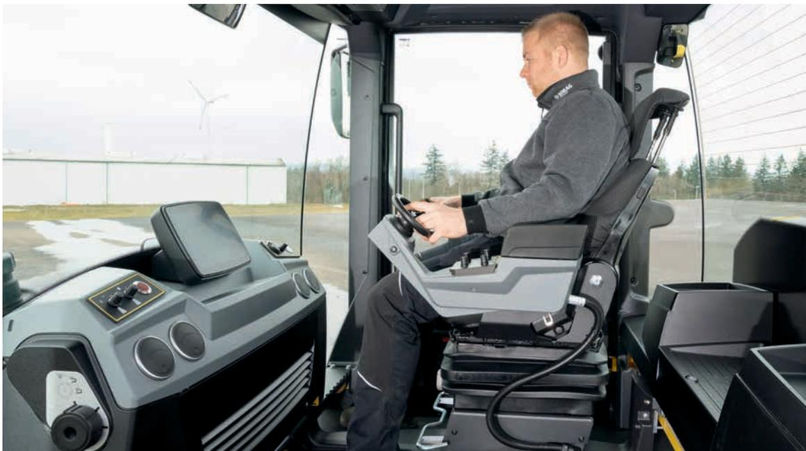
Diverse possibilità di regolazione del sedile e degli elementi di comando.
