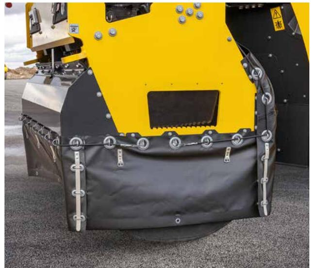
Durante la compattazione con rulli combinati, i grembiuli termici opzionali impediscono il raffreddamento delle ruote in gomma.
