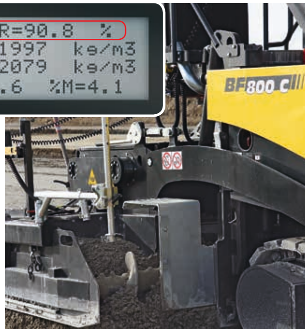
Stesa di uno strato portante di 30 cm, trattato con legante idraulico; precompattazione misurata in densità Proctor 90,8%.
