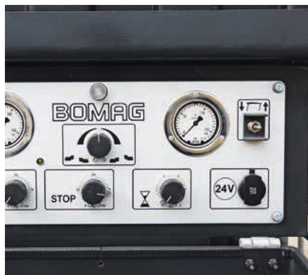
Controllo automatico per una perfetta planarità. Load Control System (L.C.S.) BOMAG
