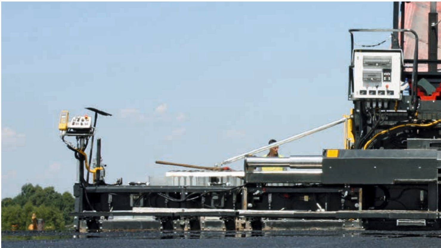
Piastre di usura fino a 40 cm di larghezza, per una perfetta planarità.
