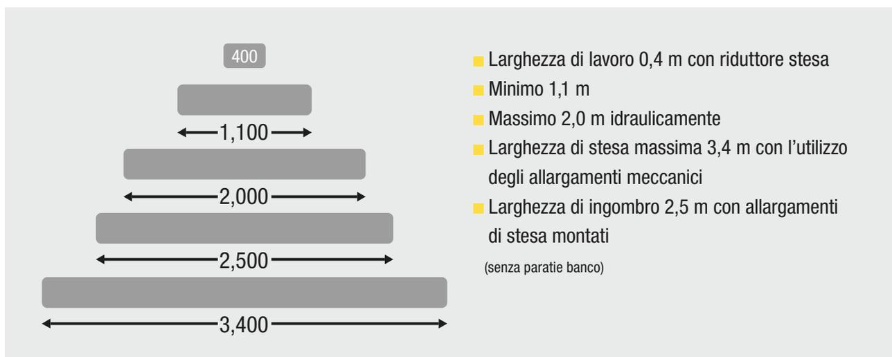
In determinate circostanze, anche il trasporto fino al luogo di impiego può risultare difficoltoso. Non per la BF 200 C-2: con le sue dimensioni compatte può infatti passare praticamente ovunque. Grazie ad un'altezza inferiore a 2 m, anche i sottopassaggi pedonali non sono un
