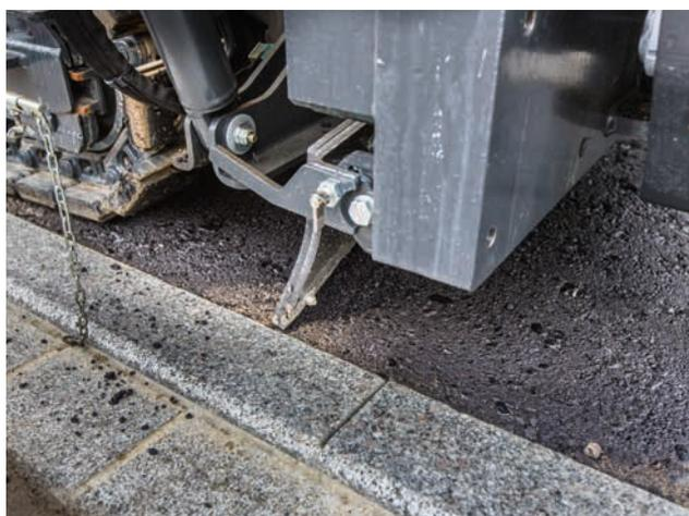
Raschiatore cingolo, la manutenzione si riduce enormemente.
