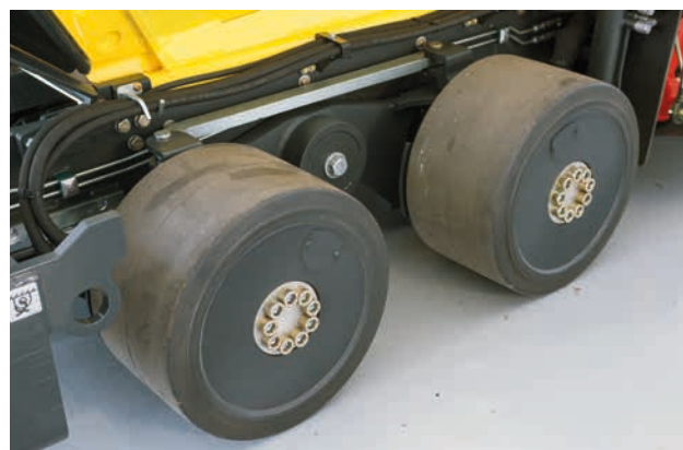
Sospensione dell'assale anteriore oscillante per il contatto costante con il terreno.
