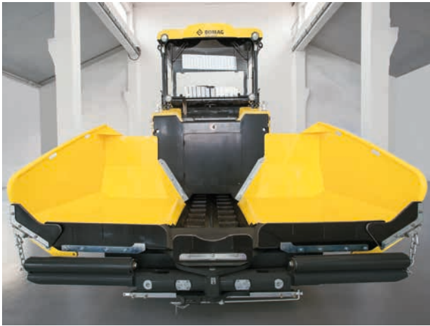
Tramoggia di grandi dimensioni.
