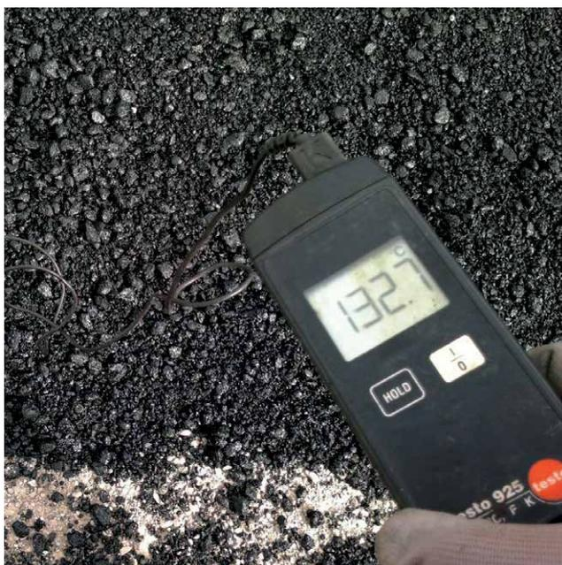
Il conglomerato tiepido (Warm Mix Asphalt - WMA) è oggi la miscela di domani. Prodotto abitualmente ad una temperatura inferiore di 30°C rispetto a quella del conglomerato a caldo, assicura alte prestazioni, simili a quelle ottenute con il conglomerato a caldo, garantendo inoltre una moltitudine di benefici:
