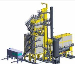
6 - Elevatore a caldo, silo filler ed elevatore filler
