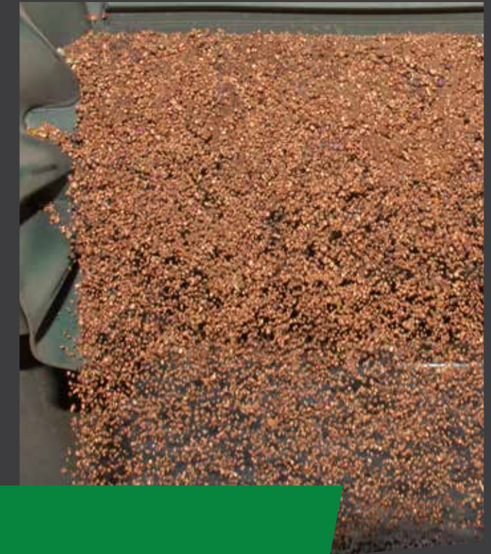
DENSIMETRIC SEPARATION TABLE: GRANULATED COPPER Tavola di separazione densimetrica: rame granulato
