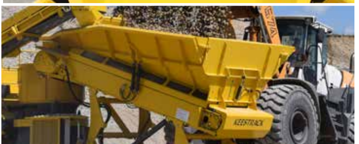
Pareti tramoggia ripiegabili idraulicamente
