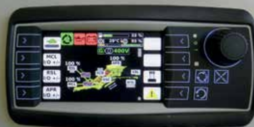
Pannello di controllo Relytec con PLC
