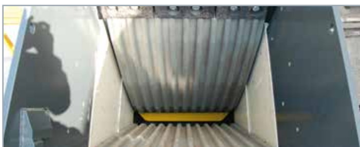
Regolazione idraulica per prevenire intasamenti
