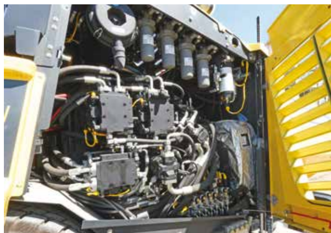
10. L'impianto idraulico della BF 600, accoppiato al motore MTU-Mercedes Stage IV da 118 kW, ha una concezione innovativa che permette di risparmiare carburante e ridurre il calore da smaltire
