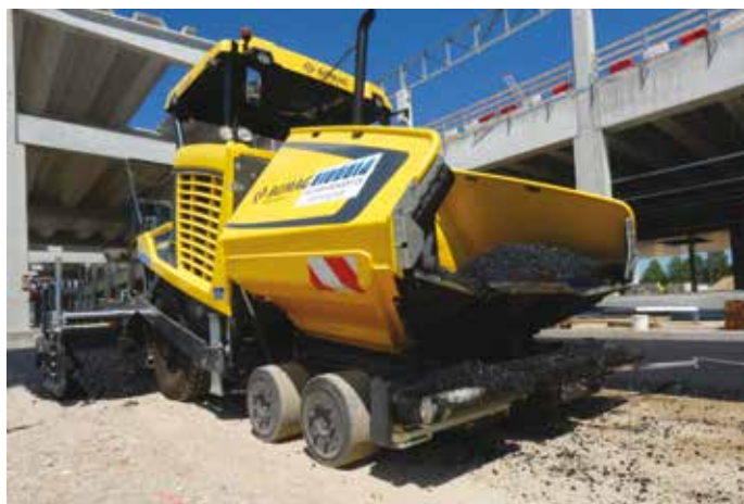
8. La tramoggia di carico della BF 600 ha una capacità di 7 m 3 e sponde anteriori idrauliche che permettono una perfetta ritenzione del materiale in fase di stesa
