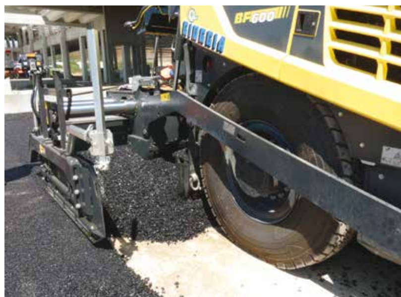
12A e 12B. Il rasatore della BF600 è uno dei punti di forza di questa macchina grazie alle soluzioni brevettate come il riscaldatore elettrico Magmalife che permette di uniformare la temperatura e avere un minore impegno energetico; ha inoltre una precompattazione molto efficiente grazie ai rasatori dall'elevato peso proprio, piastre di usura lunghe con frequenza di vibrazione combinate con quelle del tamper
