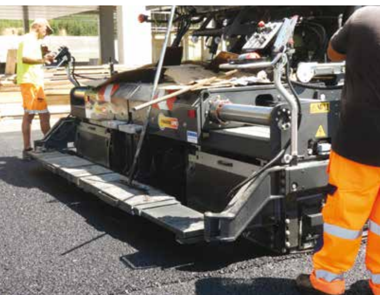
12A e 12B. Il rasatore della BF600 è uno dei punti di forza di questa macchina grazie alle soluzioni brevettate come il riscaldatore elettrico Magmalife che permette di uniformare la temperatura e avere un minore impegno energetico; ha inoltre una precompattazione molto efficiente grazie ai rasatori dall'elevato peso proprio, piastre di usura lunghe con frequenza di vibrazione combinate con quelle del tamper
