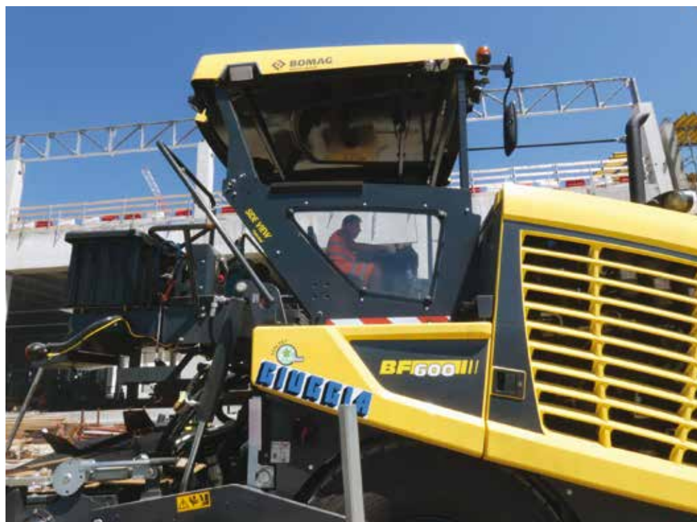
11. Il posto guida della BF 600 è dotato di piattaforma operatore traslabile che facilita la visibilità in cantieri complessi come quello del nuovo stabilimento della Fiorentini Alimentari
